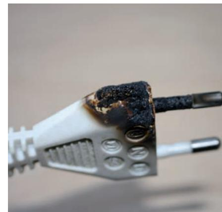
Steckdosen gibt es beim Werkeln immer zu wenig, so dass mit Mehrfachsteckdosen gearbeitet wird. Allerdings ist die Last für viele Steckdosen zu hoch, wenn daran viele leistungsstarke Geräte betrieben werden. Hier können schnell Schmorbrände entstehen.
